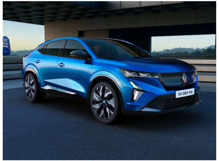
Le nouveau **Renault Rafale** est un SUV coupé qui repose sur la platedorme CMF-CD. Pour son lancement, il héritera de l'E-tech hybride de 200 chevaux. Equipé de la technologie 4 Control, la maniabilité devrait être son point fort. Une motorisation hybride rechargeable plus puissante à 300 chevaux avec un train arrière électrifié permettra de proposer une version 4X4.
