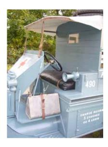
Le compartiment ambulance pouvait recevoir deux brancards sur le plancher et un troisième au dessus reposant sur deux rails. On pouvait relever ceux-ci et descendre deux bancs pour quatre blessés assis.
