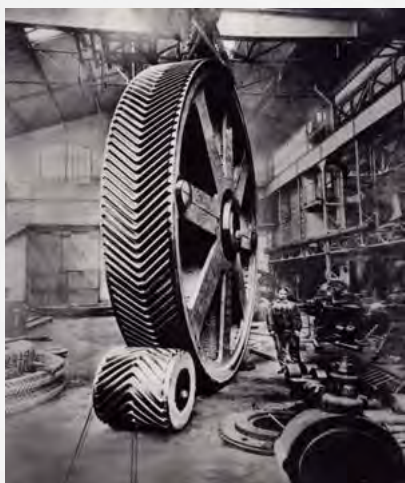
Système d'engrenages aux dents en V renversé Crédits photo : Citroën Communication
