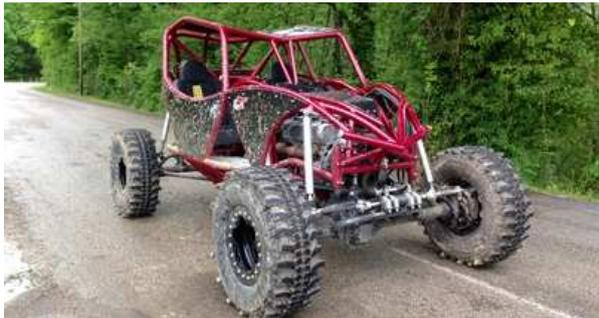
*Véhicule tout terrain tubulaire de 2016. Il a la particularité d'avoir de très grosses capacités de franchissement et est visible sur de nombreux événements aux quatre coins de la France. Il est équipé de roues d'un mètre de diamètre et d'un v8 Mercedes de 300 cv et est piloté par une femme.*
