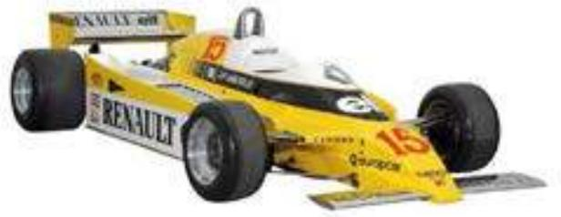
*Modèle exposé : F1 Renault RS 14 (4<sup>e</sup> châssis construit de la série RS 10) – Année 1979 - moteur 6 cylindres en V en position centrale, 1492 cm<sup>3</sup> turbocompressé - 520 ch*
