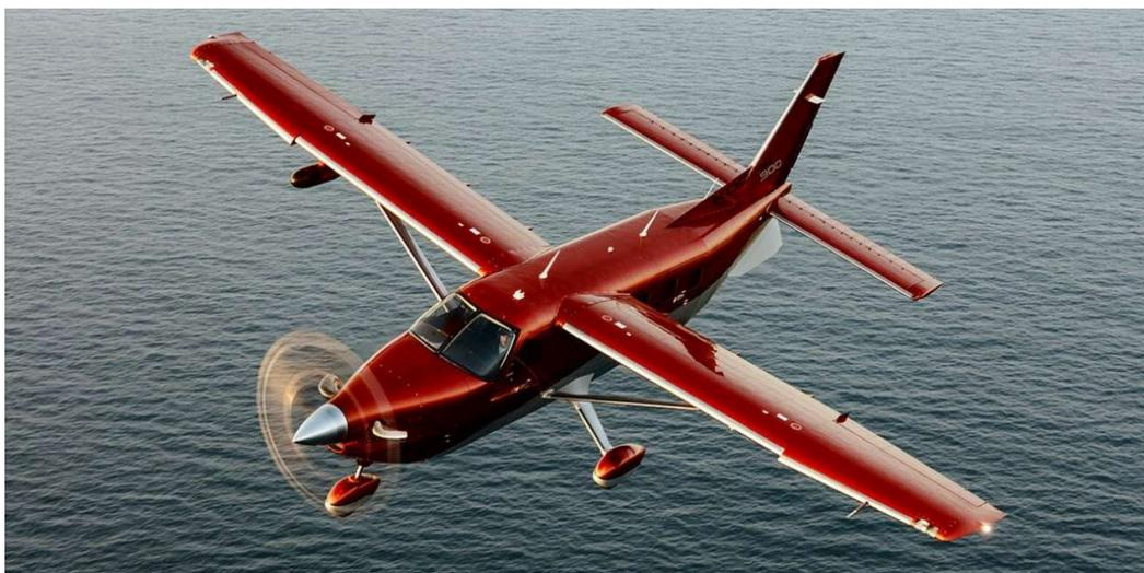
**Km/h.)** et consomme **9%** de carburant en moins grâce à son turbopropulseur **PT6A-140A** de 900 chevaux de **Pratt & Whitney**. Une nouvelle hélice composite à **cinq** pales (à vitesse constante et à commande hydraulique **Hartzell**) permet de contenir les émissions sonores à **79,5 dB**. Le nouveau Kodiak 900 est
