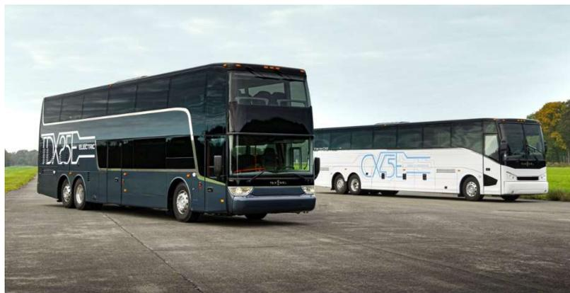
châssis fabriqués depuis près de **40 ans**. Le nouveau **TDX25E** peut accueillir jusqu'à **69** passagers (**18 au niveau inférieur + 51 à l'étage**) et possède une autonomie pouvant aller jusqu'à **500 km** si les conditions climatiques et la
