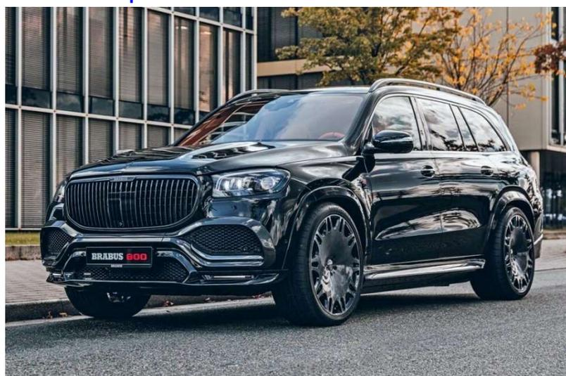
tutoient des sommets avec **800 ch.** et un couple maximal de **950 Nm.** La puissance est transmise aux quatre roues par l'intermédiaire d'une boîte automatique à **neuf rapports.** L'imposant SUV de **2,8 tonnes** avale le **0 à 100 km/h** en seulement **4,5 secondes.** tandis que la vitesse de pointe est limitée électroniquement à **300 km/h.** Cet accroissement de
