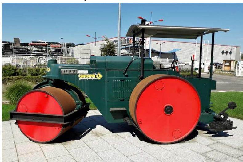
Le modèle 8W fut présenté en 1941 et fut construit sous diverses versions jusqu'à 1960. Ce rouleau d'un poids de 10 tonnes était entraîné par un moteur Diesel à 2 cylindres 4 temps (type F125z) de 4875 cc3 développant 36 ch à 1200 tr / min. La version présentée dans ces lignes est un modèle de 1954 qui trône fièrement devant les établissements Groppi à Margencel (fondés en 1971 et spécialistes du terrassement).
