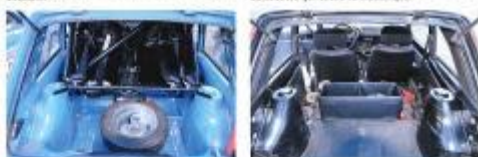
Sur la version Coupe, le montage de l'arceau de sécurité contribue également à la rigidité de l'ensemble.
