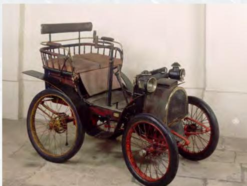
Voiturette Renault - Carrosserie du type Tilbury, moteur monocylindrique à ailettes de 1 3/4 CV fabriqué par la Firme de Dion-Bouton
